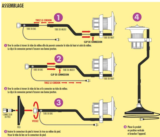
Une fois la lampe assemblée, la placer sur la terrasse ou dans le jardin, de préférence à l'écart de l'humidité puis la brancher. La lampe s'allume dès que la luminosité extérieure diminue, à la tombée de la nuit. Attirés par la lumière ultraviolette, les insectes sont immédiatement aspirés par le courant d'air provoqué par le ventilateur, dans le bac collecteur où ils meurent par dessèchement dû au courant d'air.
