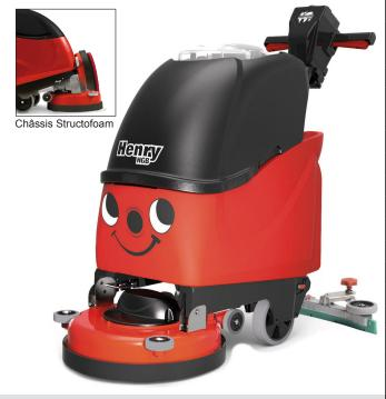
Autolaveuse HENRY à traction semi-automatique équipée de batteries gel 55Ahr (gel 24V sans entretien et sans cycle de charge) avec chargeur intégré. Très compacte et possédant un réservoir de 30L, son système permet de changer aisément les brosses ou les disques. Elle est dotée d'un timon de commandes ergonomique, et ultra simple à l'utilisation. Le châssis est en Structofoam, matériau imputrescible inoxydable, très robuste et léger.
