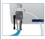
La Centrale Evolution est équipée d'un système Venturi by-pass qui permet l'aspiration du produit grâce à la pression d'eau.
