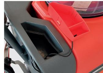
Ouverture de remplissage du réservoir d'eau propre
